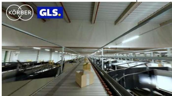
y dos irregulares, con una solución tecnológica avanzada que incluye el revolucionario sistema Visicon, capaz de singularizar los paquetes de manera rápida, al registrar su forma, tamaño y posición relativa en la cinta, y un small sorter. Con esta información en tiempo real, el sistema puede estipular importantes parámetros como la separación, orientación y dirección de salida, lo que optimiza los flujos de entrega.
